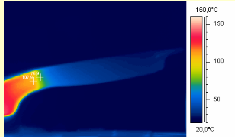
Thermogramm des Pfannengriffs
